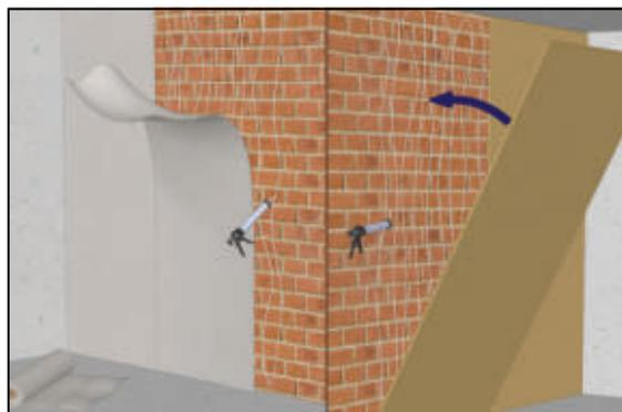
**2** Звукоизоляционные панели крепятся к стене через установленную демпфирующую прослойку помощью акустических дюбелей **SoundGuard DA-P**, которые забиваются в предварительно просверленные через панель в стене отверстия.
