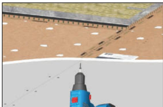
**10** Финишный слой ГКЛ крепится вразбежку саморезами ГМ 3,5×45 к профилю каркаса с усилением соединения с гипсоволокнистым листом при помощи точечного нанесения герметика **SoundGuard Seal**.
