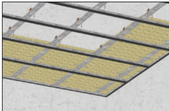
**7** Саморезами ГМ 3,5×25 к каркасу крепятся звукоизоляционные панели **SoundGuard**. Каркас обшивается панелями вразбежку по отношению к предыдущему ряду, вплотную к стенам.
