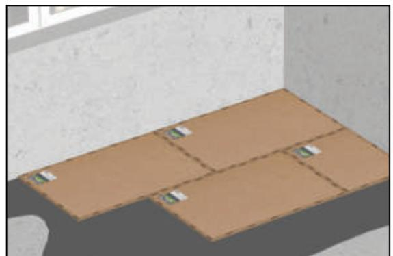
**2** После высыхания клея швы между панелями и стенами заполняются герметиком **SoundGuard Seal**. Стыки между панелями заполняются герметиком **SoundGuard Seal** и проклеиваются самоклеющейся лентой **SoundGuard Tape**.
